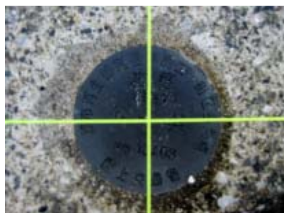
基準点埋設後の点検
