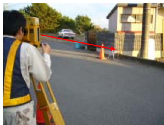
TSによる視準(A引照点～基準点)
