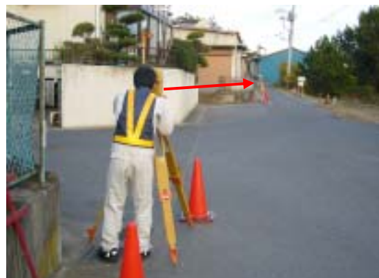
TSによる視準(A引照点～B引照点)
